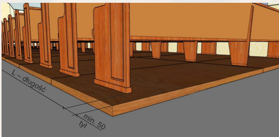
Wielogabarytowa wyspa grzejna Sterowanie sekcyjne – czasem, temperaturą i mocą
