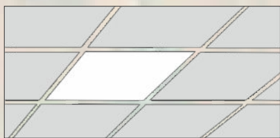
Montaż płyty w konstrukcji sufitu podwieszanego
